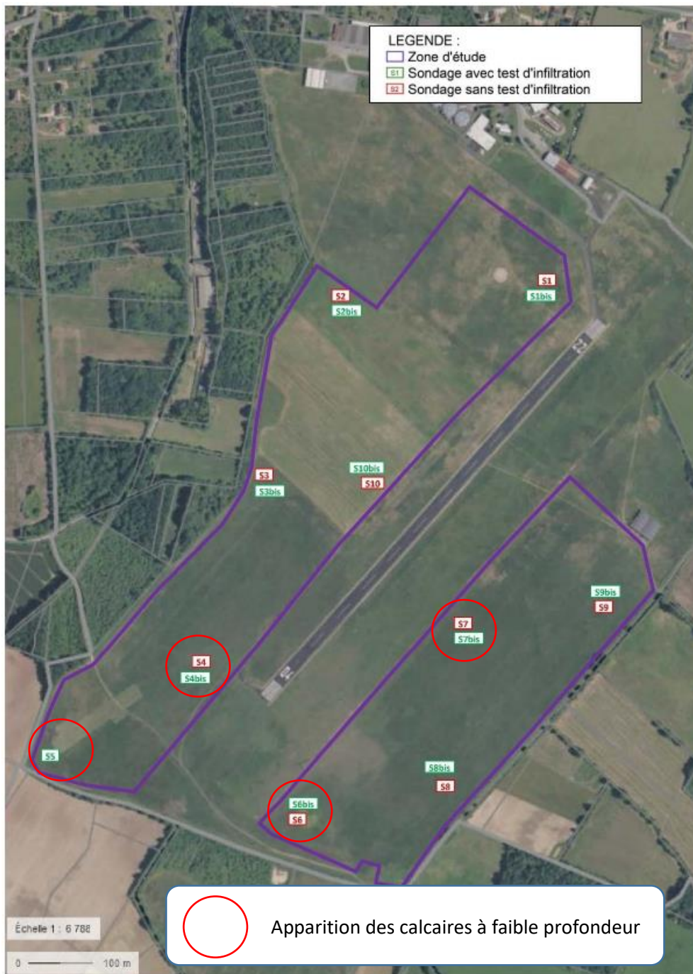
Figure 5-2 : fosses et sondages géologiques réalisés dans l'emprise du projet (Comirem Scop et SOND&EAU, Mars 2022)
